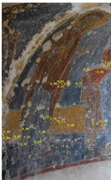
Fig. 7. Mappa delle misure RXF nell'abside S (Dati: CNR-ISTM, sezione di Perugia)
