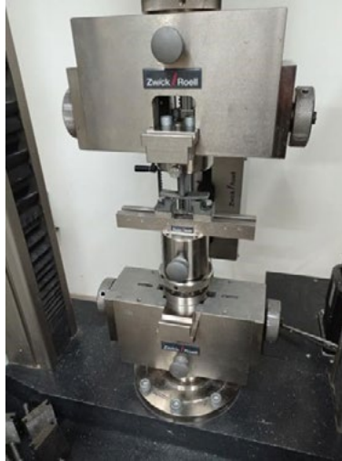
Fig.1 - Configurazione della piegatura a 3 punti / 3point bending set-up.
