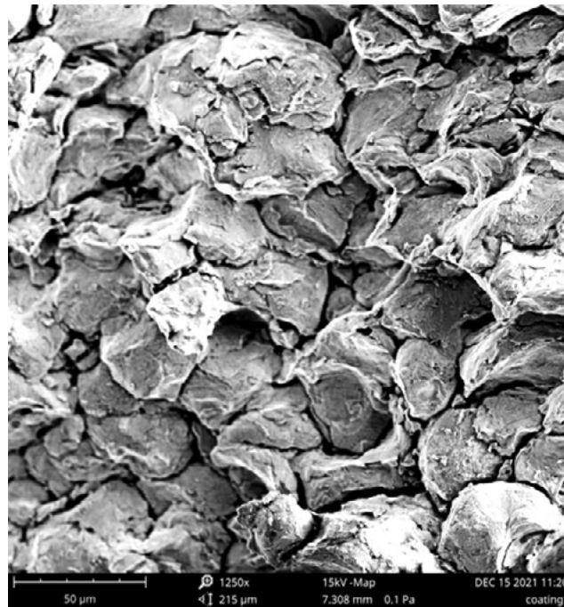
Fig.23 - Caratteristiche di duttilità locale osservate alle interfacce particella-particella dopo la frattura. / Local ductility features observed at the particle-particle interfaces after fracture.
