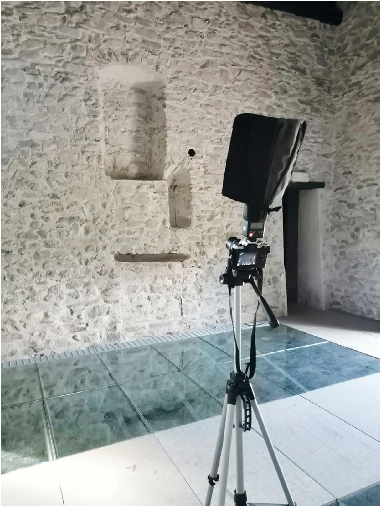
*Figura 3.* Il diffusore montato sul flash a slitta che ha consentito di ottenere degli scatti di buona qualità.
