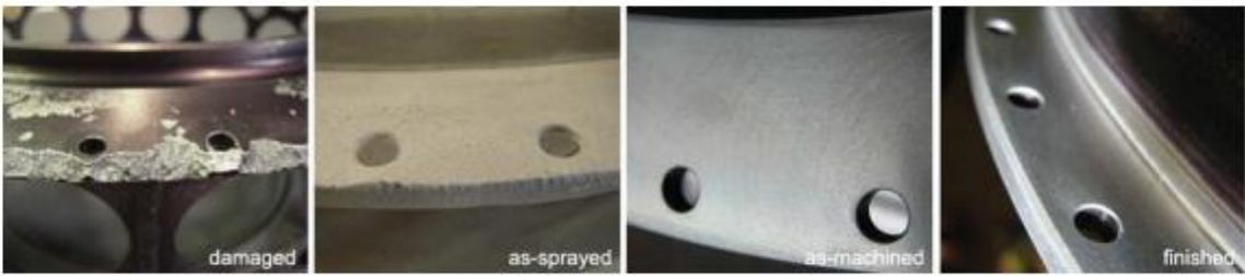
Fig. 29. Restoration procedure via CSAM.
